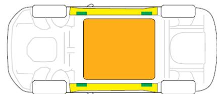
Áreas de elevación apropiadas    Batería de alto voltaje
