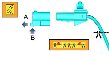
Abra el capó, extraiga el clip de la desconexión de servicio manual (A), presione el extremo del clip (B) y retire la desconexión de servicio manual.
