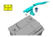
Desde el interior del vehículo, tire de la manilla de liberación del capó (B). Mueva la manilla de liberación del pestillo de seguridad en el conjunto de bloqueo del capó en la dirección de la flecha (A) para liberar el capó. Apague y desconecte el cable negativo de batería de bajo voltaje de 12V.
